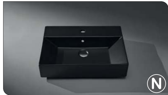
Waschtisch MODENA mit Überlauf, mit Armaturlochbank 600 x 420 mm Becken eckig Schwarz matt Beckeninnentiefe 100 mm
