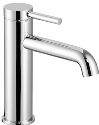
280 6005 010 Waschtisch-Einhebelmischbatterie Auslaufhöhe 107 mm mit Keramik-Kartusche mit Design-Schaftventil 1 1/4" mit Verschluss mit Flexschläuchen 3/8" single lever basin mixer
