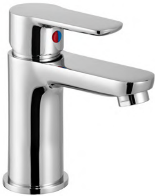
180 6000 010 Waschtisch-Einhebelmischbatterie mit Keramik-Kartusche mit Ablaufgarnitur 1 1/4" mit Flexschläuchen 3/8" single lever basin mixer
