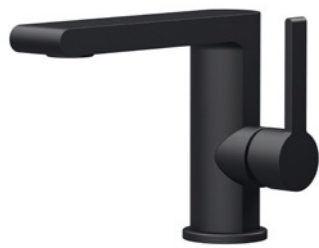
230 6000 040 Waschtisch-Einhebelmischbatterie Auslaufhöhe 100 mm mit Keramik-Kartusche mit Flexschläuchen 3/8" passende Ventile s.S. 40 ff. single lever basin mixer
