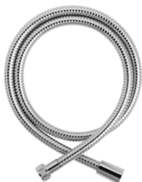
990 7332 010 Metall-Brauseschlauch 1.250 mm premium mit Drehkonus 1/2" x Rändelmutter 1/2" und Knickschutz metal shower hose
