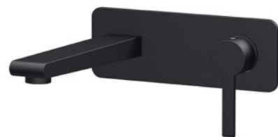
230 6051 040 Waschtisch-Einhebelmischbatterie mit Unterputz-Einbaukörper 1/2" Ausladung 175 mm mit Keramik-Kartusche Verlängerungs-Set s. Ersatzteile single lever basin mixer
