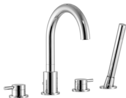
280 6170 010 Wanne-Brause-Batterie 4-Loch mit Brause mit Keramik-Innenoberteilen 90° mit Auslauf und Umstellung eigensicher gegen Rückfließen Ventil Kaltwasser linksschließend Ventil Warmwasser rechtsschließend Montageplatte und Montagegestell s. Seite 33 bath-shower mixer
