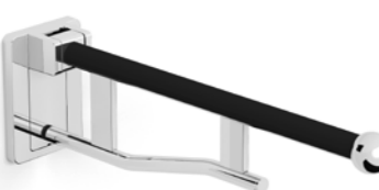
900 4710 010 Stützklappgriff 600 mm nach oben klappbar, gebremste Ausführung, Oberseite des Griffs mit Kunststoff ummantelt. Das Befestigungs-Set bitte separat bestellen. Siehe Seite 159 foldable grab rail 600 mm
